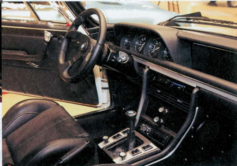
↓ここまでやるかというくらい手が入ったインテリア。インパネは内部に現代のACエアミックスユニットを入れる関係で数センチほど後方に取り付け位置を移動しており、見事にその形跡を消している。インパネ周りは本革を張り込んでいるが、作業は素晴らしい。レカロシートも本革で張り替え背もたれに3.0CSの刺繍まで……。
