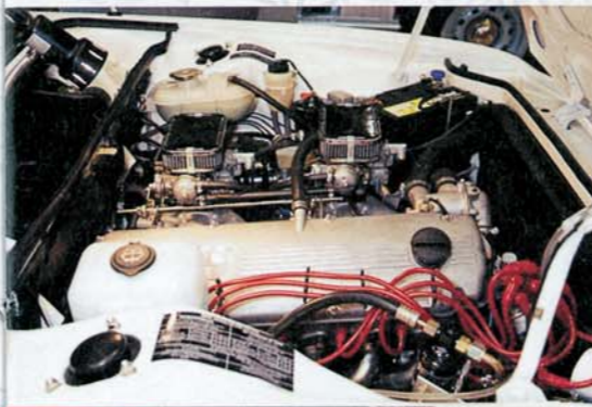
↑見極上オリジナル仕様フルレストアだが、ラジエーターも電動ファンも国産現代パーツ、ブレーキ制御系はまんまトヨタ移植。エアコンはコンプレッサー/コンデンサー/リキッドタンク/室内ユニットまで現代ユニットに総交換という驚愕のスーパーアップデイト車だ。作業の技術レベルは非常に高く感銘を受けた。
