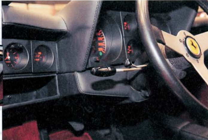
↑左の365GT/4BBのレストア内装のアップ。革も上質だが、縫製部が造形端部にびったり沿っていること(型紙)、縫製部すっきり感(裏すき)、肉(内パッド)、縫製そのもの(ミシン/針/糸/運行)など、いずれも適切・完璧だ。
